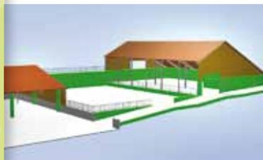
Das moderne Heizhaus mit zwei Biomasse-Heizkesseln wird unsere Ölheizung ersetzen. Das Dach ist optimal nach Süden ausgerichtet, damit eine 500 m<sup>2</sup> Photovoltaik-Anlage von uns montiert werden kann. Die Eröffnung ist im Herbst 2011 geplant.
